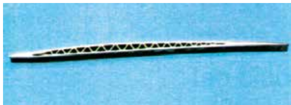
► 具有桁架结构芯的风扇叶片剖面图
