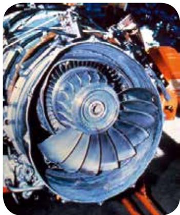
► 风扇叶片遭鸟击受损情况
