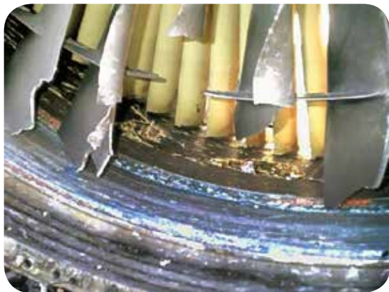
► 发动机风扇叶片被鸟撞击遭到损伤
